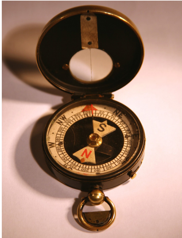
Kieszonkowy kompas wojskowy z okresu I wojny światowej z widoczną różą kompasową
