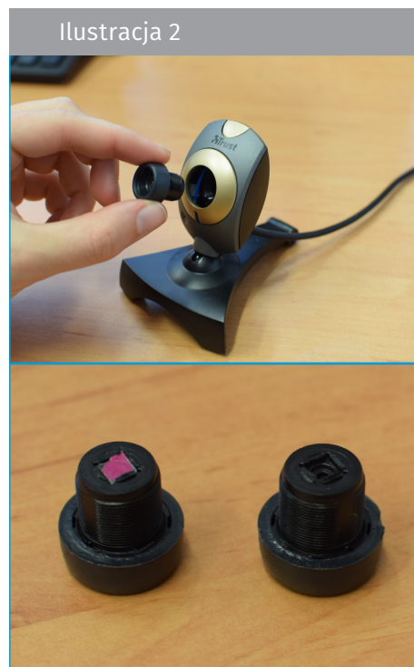
↑ Wyjmowanie obiektywu i filtra podczerwieni
